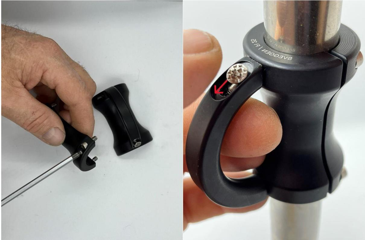
**Hinweis: Ziehen Sie die Schrauben nacheinander leicht an und verriegeln Sie sie dann nach und nach. Ziehen Sie mit dem kurzen Teil des Inbusschlüssels fest, um die Schrauben nicht zu brechen.**
