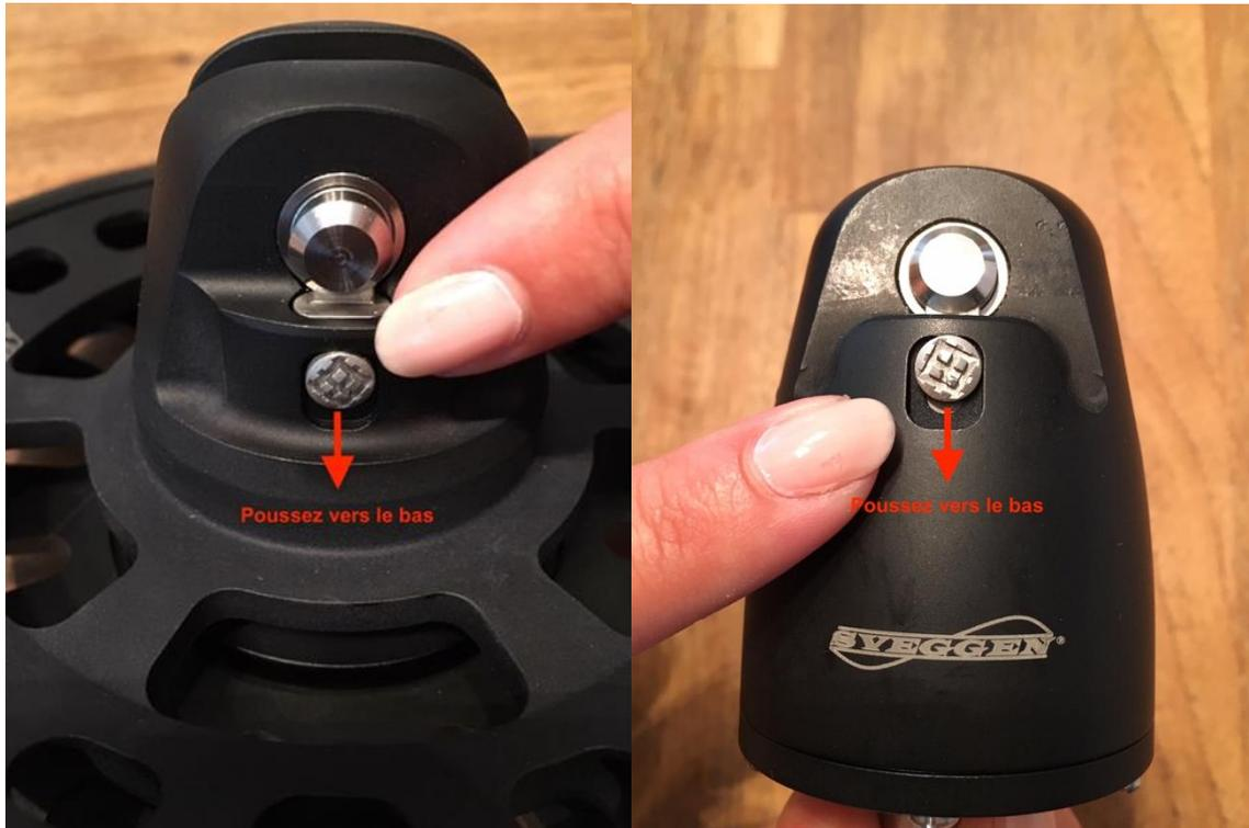
**Nach dem Spülen können Sie diesen Mechanismus am Ende der Saison ölen, Windenratschenöl, Waffenkammer oder anderes, es ist möglich, den Rändelknopf abzuschrauben und den Scheffel zur Wartung zu entfernen: um mit TEFGEL oder Marinefett wieder zusammengebaut zu werden.**
