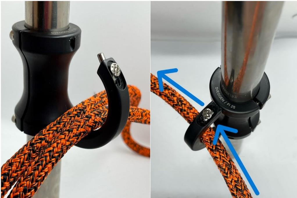
**TIPP: Es ist möglich, den Körper des Spinners als Reibring zu verwenden, wenn der Leinenwinkel zu offen ist: Bei Mehrtrumpfbooten, um die Leine vom Bugspriet über den Steuerbord- oder Backbordtrumpf zu führen, ist dieser Trick unerlässlich!**
